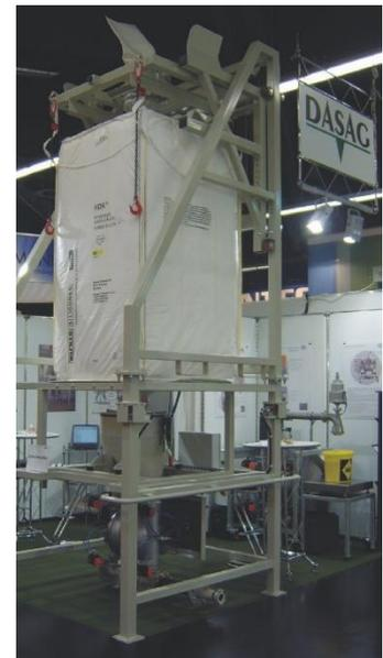
Pulverpumpen sind häufig Teile von kompletten Systemen zum Transport von Schüttgütern in Dosier-, Misch-, Verpackungs- oder Recycling- Anlagen, z.B. in der Baustoffindustrie und der chemischen Industrie.
