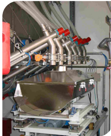
Automatisches Dosiersystem für Pulver mit verfahrbarer Kippwaage
